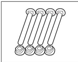
x4 - Boulons de carrosserie et écrous de 3 po
